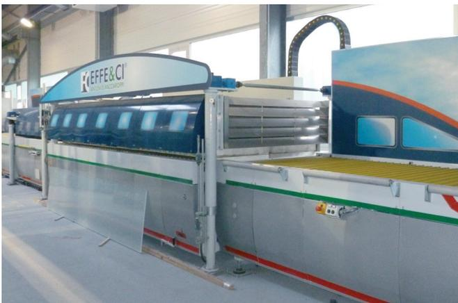
Vorspannofen zur ESG-Produktion
